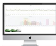
Un portail dédié permet de suivre en temps réel la recharge des véhicules et le taux d'autoconsommation de la toiture photovoltaïque.
